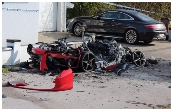
Figur 25: Bilden visar en Ferrari där kolfiberkomposit exponerats och spridits över en större yta i ett villakvarter utanför Karlskrona efter explosion och brand i fordonet. Foto: sr.se
