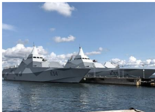
Figur 26: Två av Försvarens korrvetter av Visby-klass vid sin hemmakaj i Örlogshamnen, Karlskrona. En korrvelt är till största delen byggd av kolfiberkomposit. Foto: Försvarensmakten
